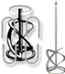
Рис. 12.4. Насадка у вигляді лівосторонньої спіралі
